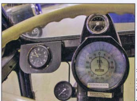
Der Fahrerplatz mit dem Fahrtenschreiber und, ganz links, der Uhr.
