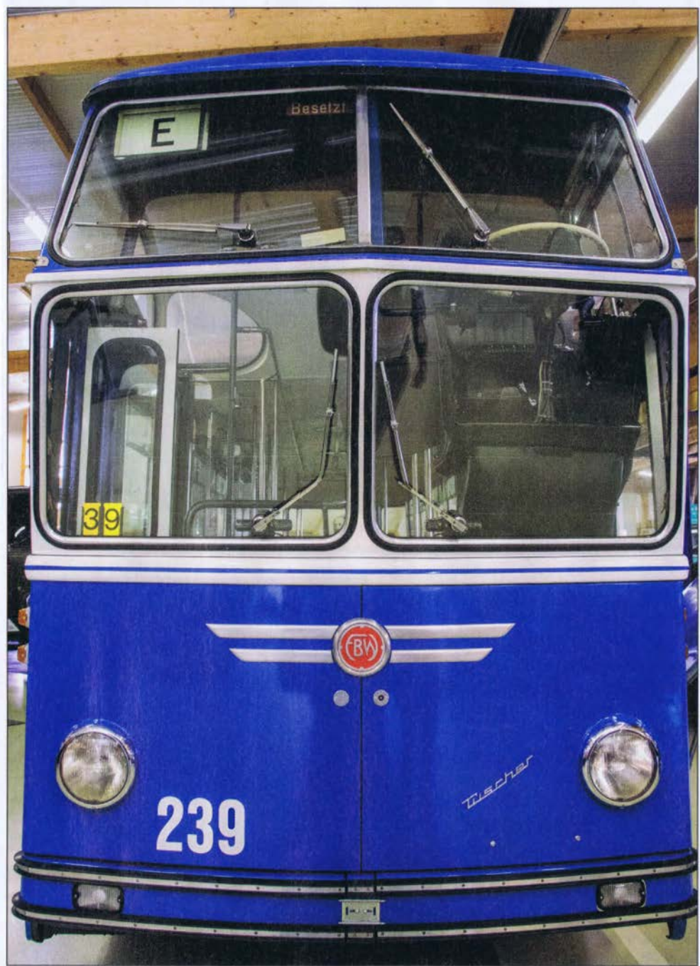
Auffällig sind der Tüscher-Schriftzug neben dem Scheinwerfer sowie die unterschiedliche Form der Scheibenwischer, je nachdem, ob sie an den unteren oder den oberen Scheiben angebracht sind.
