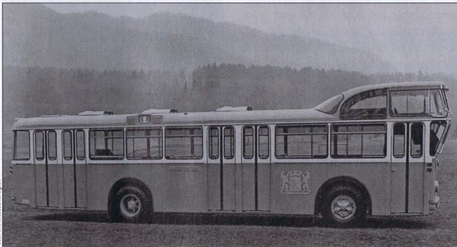
Hier sieht man gut den erhöhten Fahrerplatz, der sich im Sommer in eine Sauna verwandelte. Die Schiebefenster und die kleinen Windabweiser boten nur eine sehr begrenzte Belüftung.
