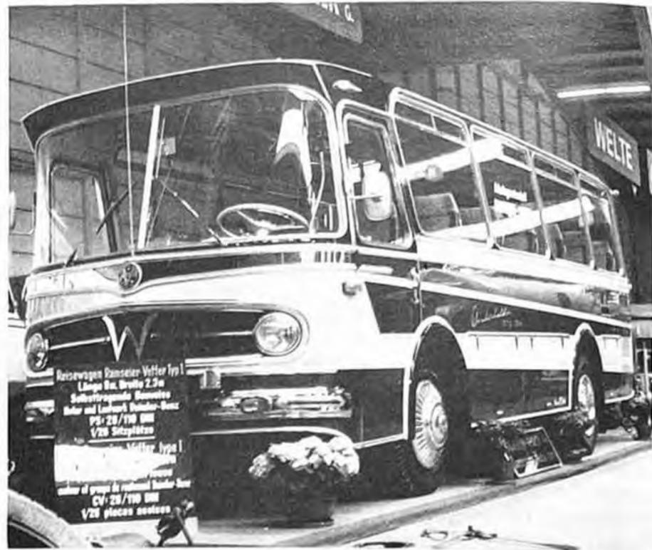
Der selbsttragende Vetter-Ramseier 28-Plätzer, der mit Teilen des O 321 H hergestellt wird. Das flache Dach und die extrem hochgezogenen Seitenscheiben geben dem Fahrzeug ein unverwechselbares Aussehen
