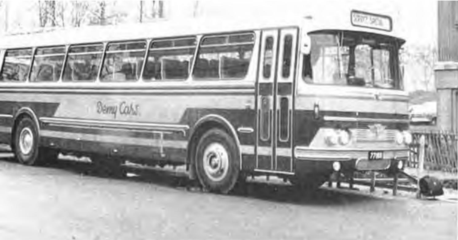
*Ein neuer englischer Omnibus der AEC „Regal“, ein 12 m-Wagen mit Jonkheere-Aufbau. Der Wagen hat Luftfederung an starren Achsen und wurde als 14-Reiher für den Gelegenheitsverkehr vorgestellt*
