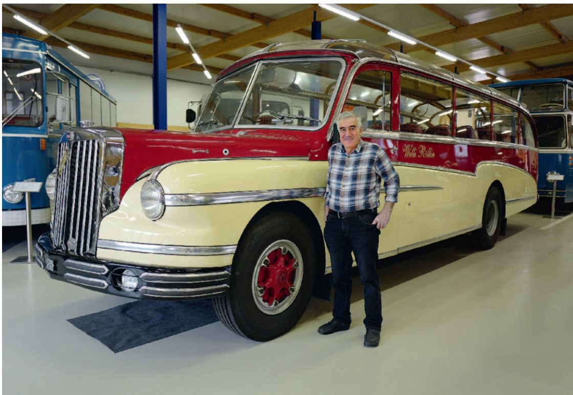
Beim 1952 gebauten FBW-Reisebus kann der Aufbau abgehoben und durch eine Ladebrücke ersetzt werden.
