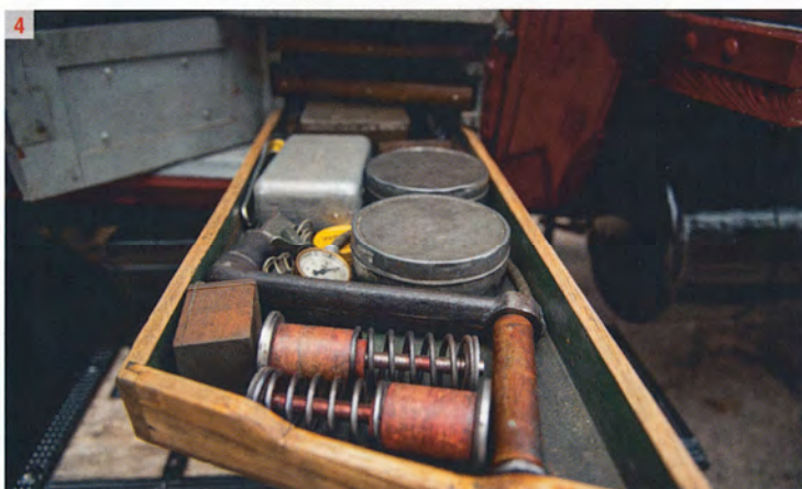
3: Goed gebruik van de ruimte: lades met... 4: reserveonderdelen en gereedschap, waaronder de slinger, 5: een hamer en diverse schroevendraaiers... 6: en steeksleutels in grote maten. 7: Eigen fabricaat carburateur
