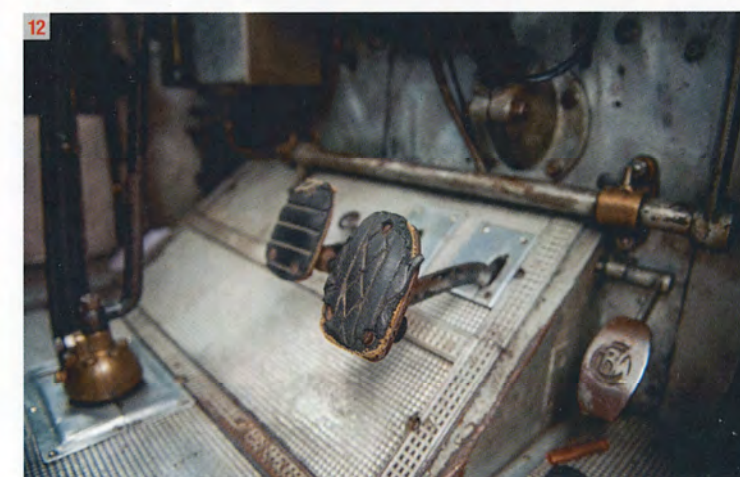
8: Dik zeven liter viercilinder. 9: Het teken dat er een aanhanger aangekoppeld is. 10: Lekker bij hoge temperaturen. 11: Een gewaarschuwd mens.... 12: Wel hydraulisch maar niet bekrachtigd.
