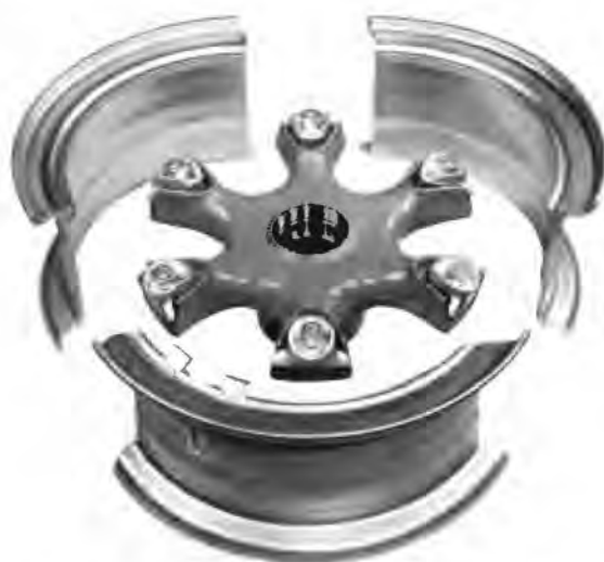
TRILEX-Einheitsradstern mit TRILEX-Felgen für Reifen mit Schlauch
